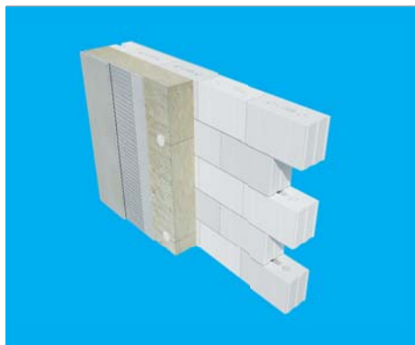
Przykład – przekrój muru: SILKA E15 + ocieplenie
