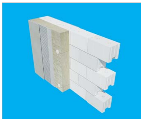
Przykład – przekrój muru: SILKA E18 + ocieplenie
