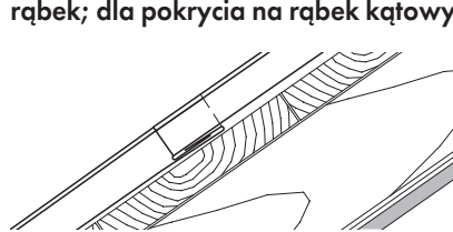
Połączenie poprzeczne: rąbek w rąbek; dla pokrycia na rąbek kątowny
