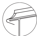
Zakończenie okapu stojące, okrągłe
