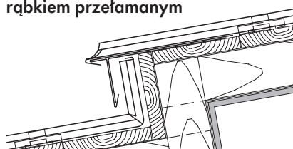
Połączenie poprzeczne: uskoku z rąbkem przetłaczanym
