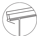
Zakończenie okapu stojące, proste
