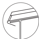
Zakończenie okapu stojące, ukośne
