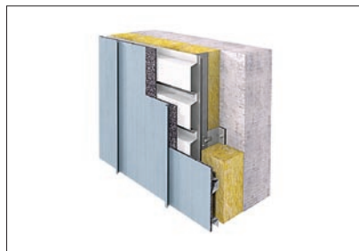
Pokrycie elewacji 2 Podkonstrukcja metalowa
