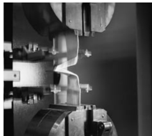
Fot. 3: Próba gięcia podczas kontroli jakości
