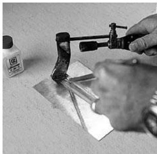
Fot. 15: Prowadzenie lutownicy
